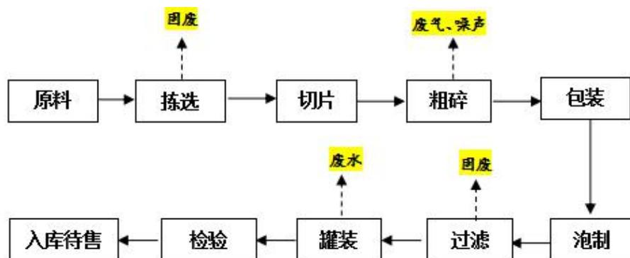
图 3-4 露酒生产工艺流程图
