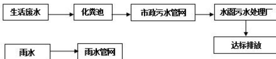
图 4-1 主要废水工艺流程图
