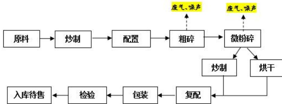
图 3-3 配置茶生产工艺流程图
